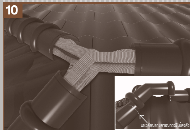
บริเวณจุดต่อระหว่างครอบตะเข้สันและครอบสันหลังคา ให้คลุมแผ่นรองได้ครอบทับกันอย่างน้อย 10 ซม. กรณีวางครอบโค้ง 3 ทางไม่พอดีให้ตัดปลายครอบสันโค้งออกทั้ง 3 ด้าน พร้อมชะระงัดก้นน้ำด้วย
