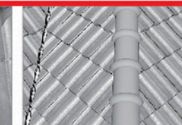
4 ติดตั้งกระเบื้องหลังคาและครอบตามคู่มือการติดตั้งกระเบื้องหลังคา เอสซีจี แต่ละประเภท
