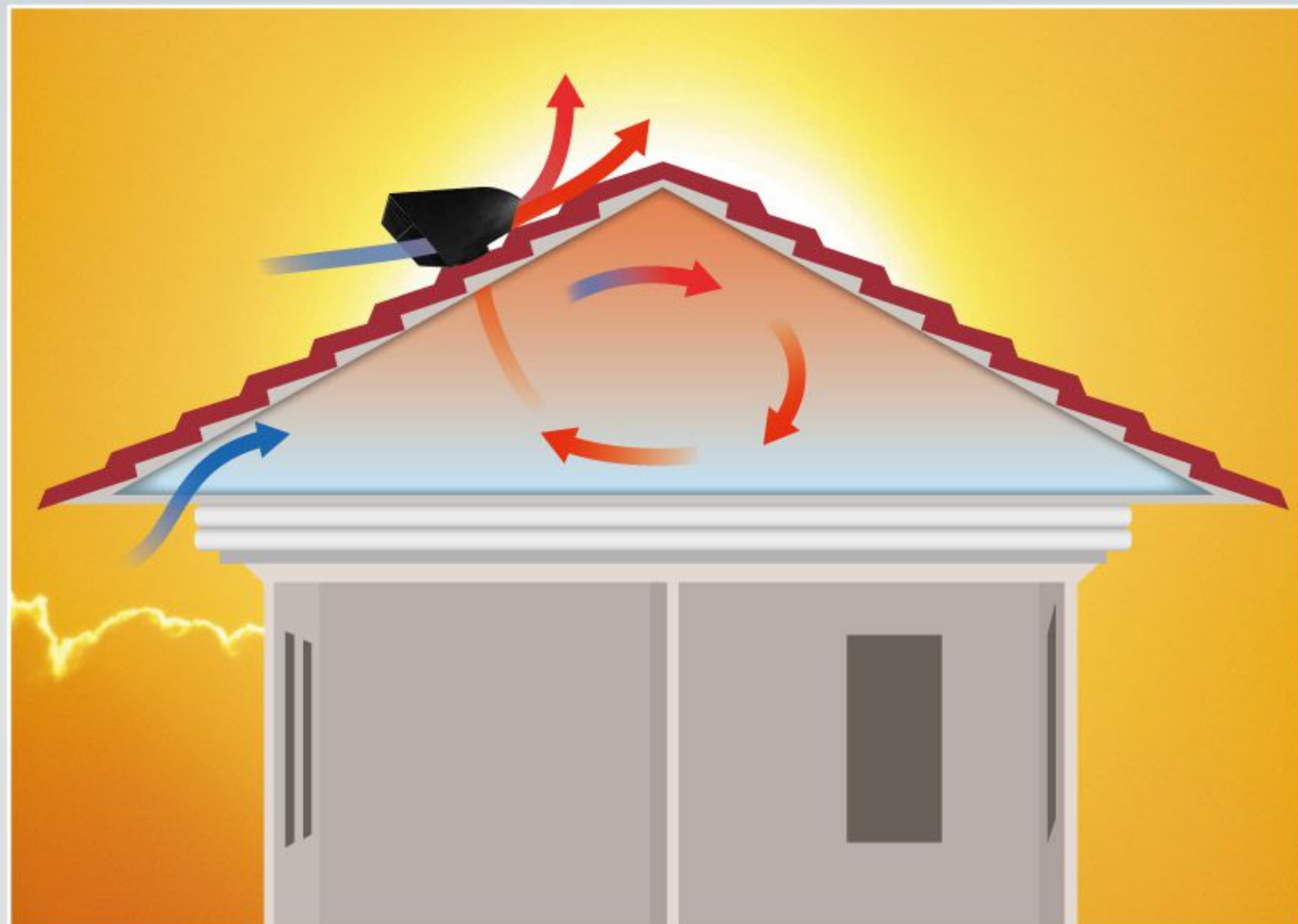
ภาพการทำงานของชุดกระเบื้องปล่องระบายอากาศ เอสซีจี
